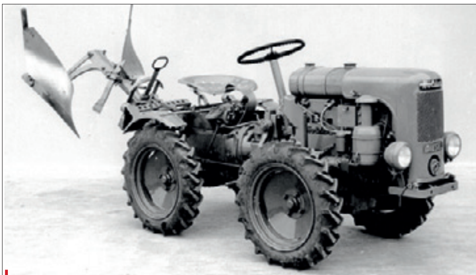
První kloubový traktor na světě, Cultitrac A 10, sjel z výrobní linky v Metzingenu v roce 1954
