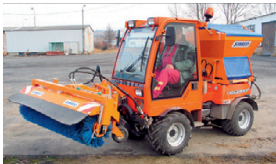
Komunální kloubový nosič Holder C Trac 2.42 používají Technické služby města Mělníka při zimní údržbě komunikací v agregaci s čelním zameřacím kartáčem (radlicí) a sypačem od společnosti Simed
