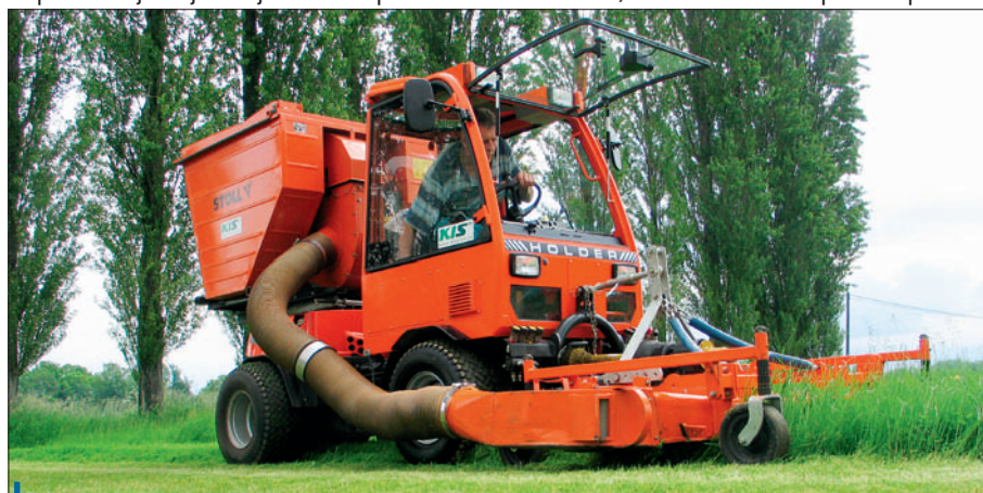
Nosič Holder pracuje v agregaci s třínožovým žací ústrojím se záběrem 150 cm a zásobníkem na 1000 litrů hmoty (od firmy Stoll) s výsypnou výškou do 190 cm. Pro zimní údržbu poslouží šípová radlice s šířkou záběru 115 cm a poloautomatickým sypačem na 0,4 m 2 materiálu od firmy Simed
