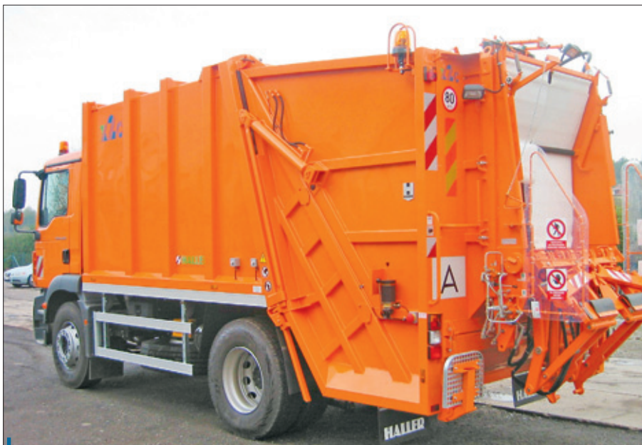
Vozový park rozšířilo vozidlo MAN 4 x 2 s nástavbou Haller s děleným vyklápěčem na nádoby o objemu 110 až 1100 l pro směsný komunální odpad
