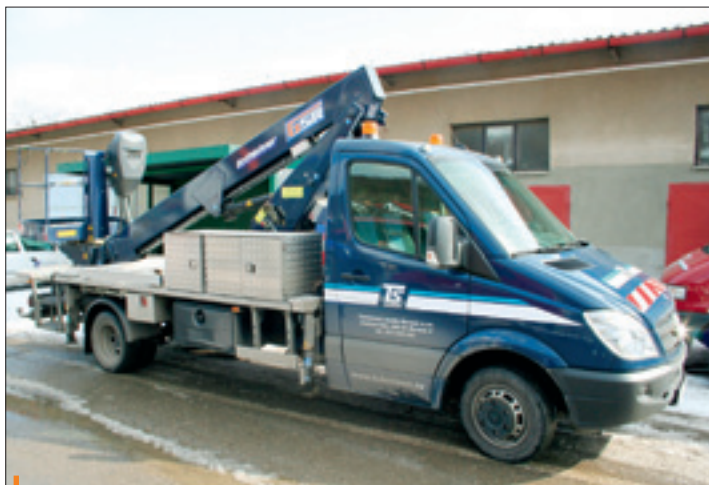
Plošina Rothlechner slouží při údržbě veřejného osvětlení
