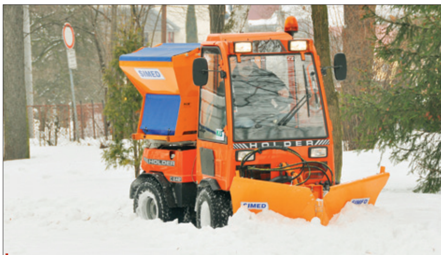
S úspěšným zvládnutím nástrah letošní náročné zimy pomáhal v Semilech nosič Holder C 245 s šipovou radlicí a sypačem o objemu 400 l. Oba agregáty jsou od firmy Simec
