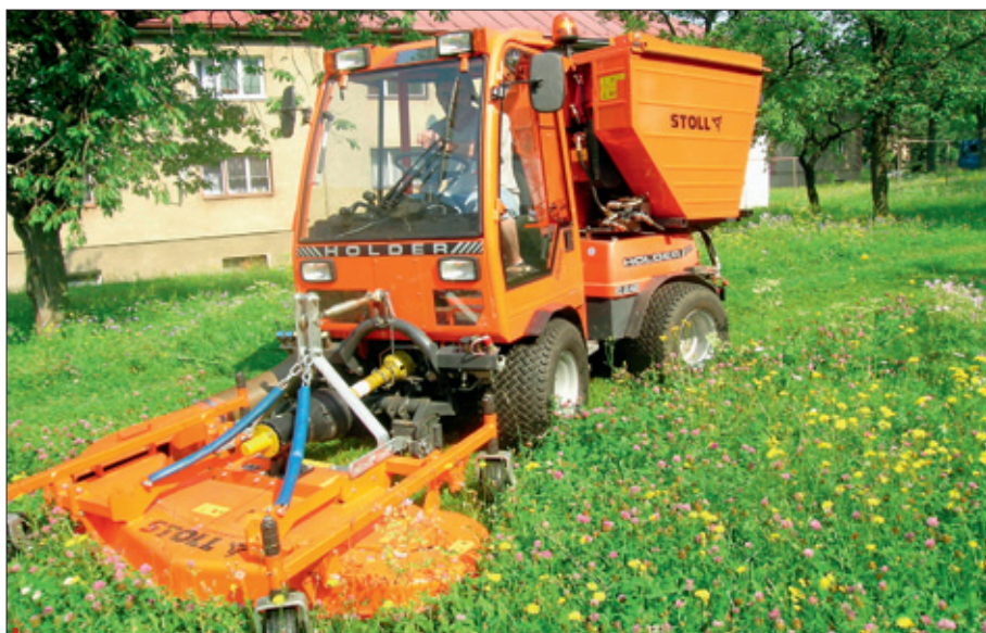
O údržbu zeleně se stará nosič s žací nástavbou o šíři záběru 150 cm a zásobníkem na 1000 l zelené hmoty se zdvihem až do výše 190 cm – výrobce Stoll
