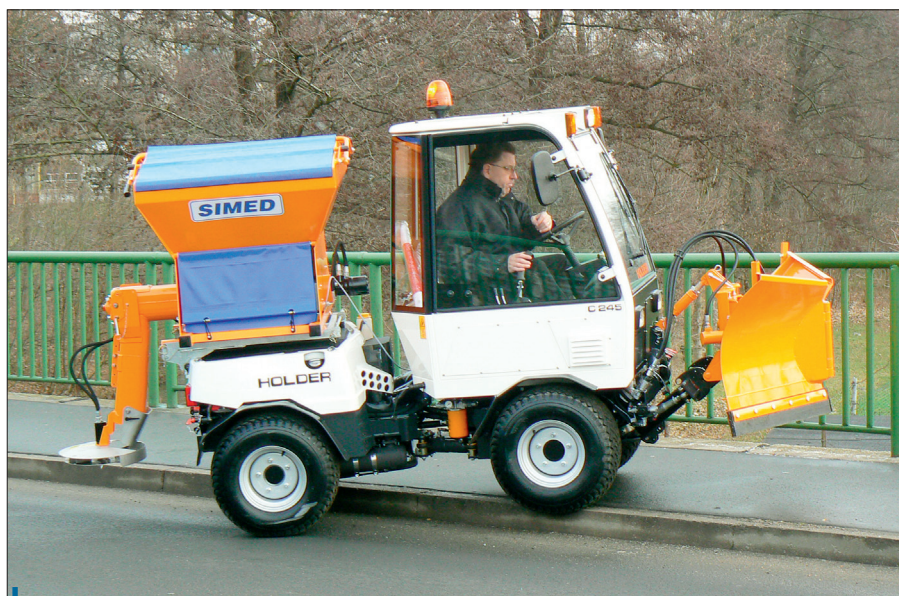
Díky kloubu se nosiče Holder (na snímku typ C 245) dostanou bez problému i na obrubníky vysoké až kolem 20 cm
